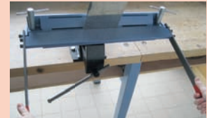
Biegen mit der Abkantvorrichtung
