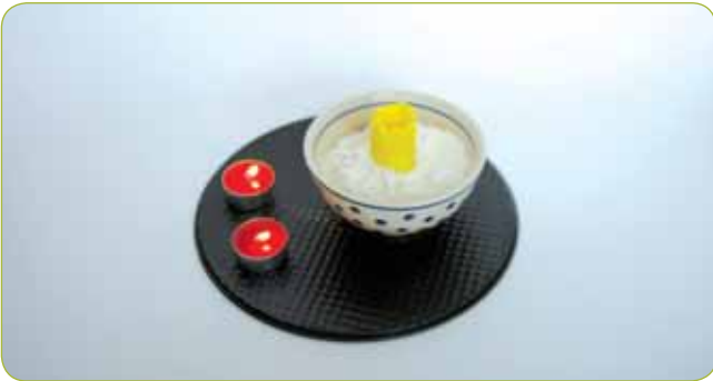
In die Schüssel wird Mehl gegeben. Die Abgussform wird mit der Öffnung nach oben vorsichtig hineingesetzt, damit sie nicht umkippt. Die zwei Teelichter werden angezündet.
